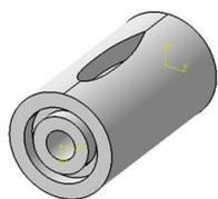
Рис. 5. Кронштейн крепления к конусу тензовесов
