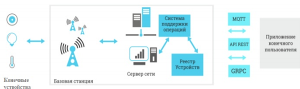
Рис. 3. Типовая архитектура сетей LoRaWAN
