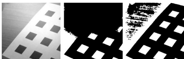
Слева направо: изображение в градациях серого; бинарное изображение, полученное методом Оцу (глобально-вычисляемый порог); бинарное изображение, полученное методом Sauvola Thresholding (локально-вычисляемый порог); Рисунок 3 – Сравнение двух методов бинаризации изображения
