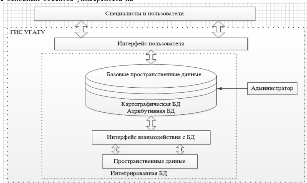
Рисунок 4. Логическая структура ГИС УГАТУ.
