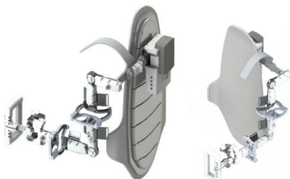
**Рисунок 11. Внешний вид разработанного экзоскелета**
