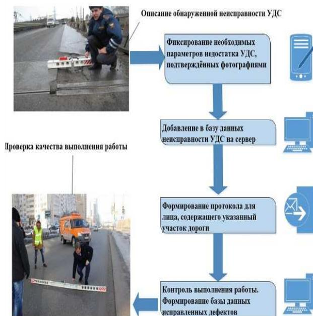
Рис. 1. Принцип работы системы
