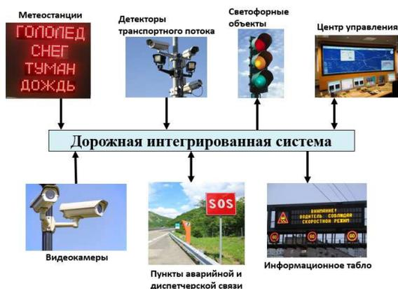
Рис. 5. Дорожная интегрированная система
