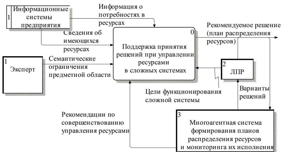
Рис. 3. Диаграмма потоков данных процесса поддержки принятия решений при управлении ресурсами сложных систем
