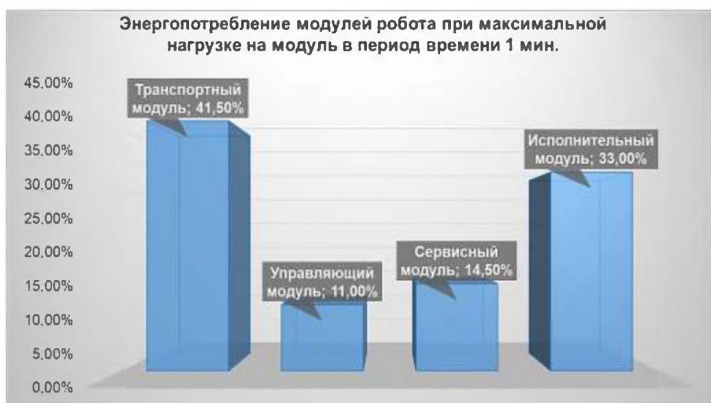
Рис. 3 Процентное соотношение энергопотребления модулей робота в период времени 1 мин
