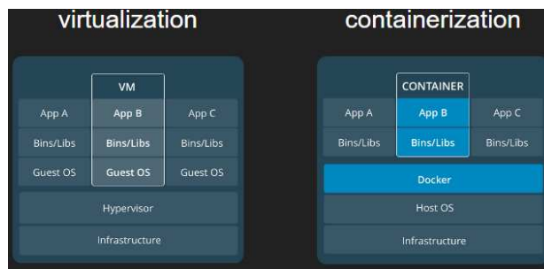
Рис. 4. Структурные отличия виртуализации и контейнеризации
