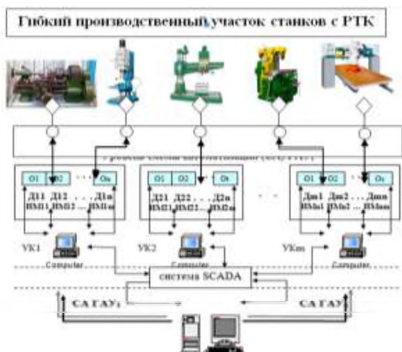
Рис. 1. Структурная схема автоматизации гибкого производственного участка с робототехническим комплексом на базе TRACE MODE
