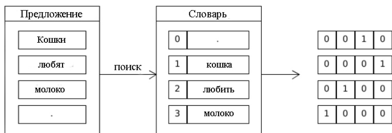
Рис. 1. Представление слов с помощью one hot кодирования
