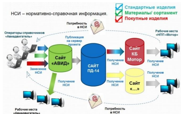
Пример внедрения PLM-системы на ПАО «ОДК-УМПО» в рамках взаимодействия по проекту ПД-14
