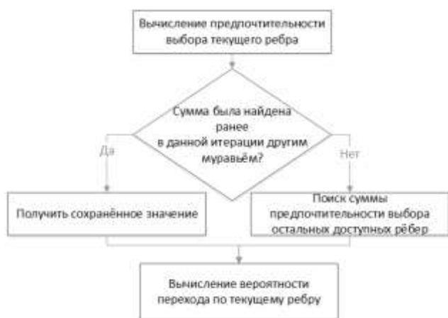
Рис. 3. Расчёт вероятности перехода по грани с использованием результатов прошлых вычислений
